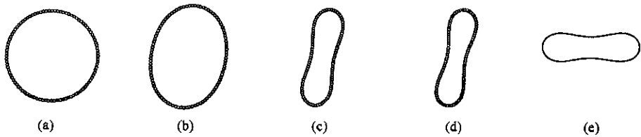
图 3 \Delta P/\kappa = 1000 , (a)–(d) 分别为 t = 500, 5000, 7500 和 25000 时的形态图 (e) 为(11)式的计算结果
